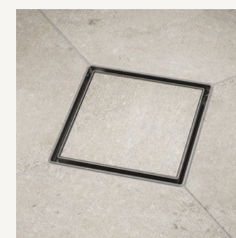
AVĀRIJAS TRAPS TECE drainpoint S ar ieflīzējamo pamatni, zemo sifonu un pretsmakas vārstu
